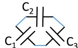
6) Tre condensatori (di capacità  $C_1 = 2 \text{ nF}$ ;  $C_2 = 3 \text{ nF}$ ;  $C_3$  incognito) sono posti in serie. Alle estremità della serie viene applicata una differenza di potenziale di 24 V. Determinare il valore di  $C_3$  per cui ai suoi capi è presente una tensione di 8 V
