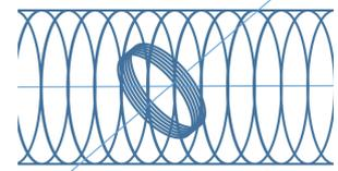
10) Un solenoide lungo  $L = 2 \text{ m}$  viene realizzato con  $D = 1 \text{ km}$  di filo di rame ( $\rho = 2 \times 10^{-8} \Omega\text{m}$ ) di sezione  $s = 0,1 \text{ mm}^2$  avvolte per formare spire equidistanti di raggio  $a = 2 \text{ cm}$ . Il solenoide viene alimentato connettendolo a un generatore di tensione continua  $f = 10 \text{ V}$ . Determinare il valore del campo magnetico al centro del solenoide
