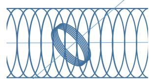
12) Al centro di un lungo solenoide costituito da  $n = 5000$  spire/m di raggio  $a = 2 \text{ cm}$  è contenuta una bobina sottile costituita da  $N = 20$  spire di raggio  $a/2$  e resistenza complessiva  $R = 10 \Omega$ . Gli assi dei due avvolgimenti formano un angolo di  $45^\circ$ ; il solenoide è attraversato da una corrente costante  $I = 0,25 \text{ A}$ .
