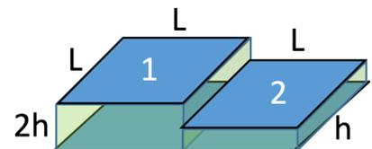
6) Nella struttura di condensatori riportata in figura le armature superiori sono due quadrati di lato  $L = 10 \text{ cm}$ , le distanze fra le coppie di armature sono  $h = 2 \text{ mm}$  e  $2h$  e la costante dielettrica relativa dell'isolante è  $\epsilon_r = 2$ .
