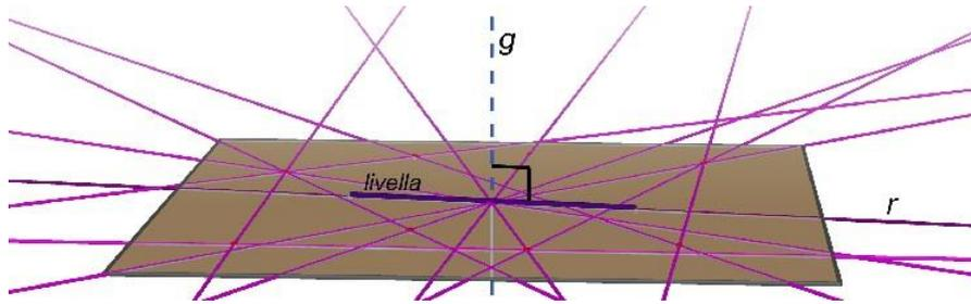
Noi abbiamo invece fatto il controllo per una sola retta. In effetti, se provassimo a chiedere ad un qualsiasi artigiano esperto di controllare se un piano è orizzontale, vedremmo che l'artigiano pone la livella sul piano, controlla che la bolla sia al centro, poi ruota la livella e controlla di nuovo che la bolla sia al centro. Se in entrambi i casi la bolla è al centro, l'artigiano afferma che il piano è orizzontale. Afferma cioè che **tutte** le rette del piano sono orizzontali.
