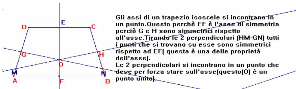
Gli assi di un trapezio isoscele si incontrano in un punto. Questo perchè EF è l'asse di simmetria perciò G e H sono simmetrici rispetto all'asse. Tirando le 2 perpendicolari (HM-GN) tutti i punti che si trovano su esse sono simmetrici rispetto ad EF [ questa è una delle proprietà dell'asse].
