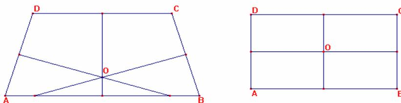
**Nel quadrato, nel trapezio isoscele e nel rettangolo gli assi si incontrano in un punto perchè almeno uno di essi è anche asse di simmetria per il quadrilatero .**
