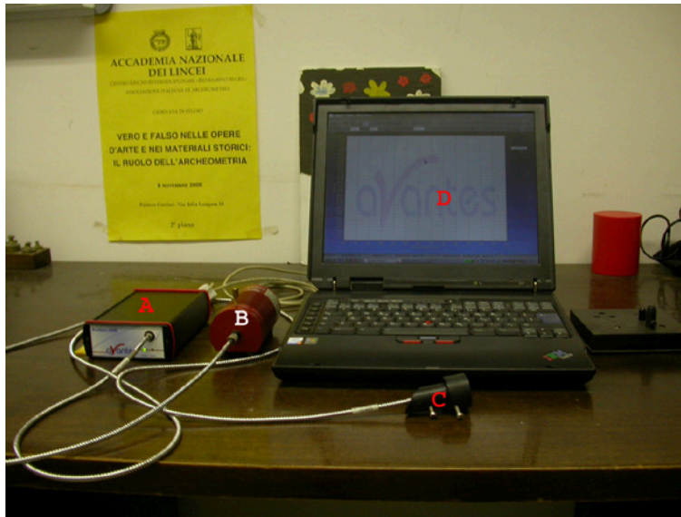
Figura 5.7: Strumentazione per misure spettroscopiche in situ su beni culturali. (A): Spettrometro a reticolo con sensore a matrice; (B): Sorgente di luce (lampada al tungsteno); (C): testa di misura; (D): computer portatile. La sorgente è collegata alla testa di misura mediante fibra ottica; la luce riflessa è raccolta da un'altra fibra ottica, collegata allo spettrometro.
