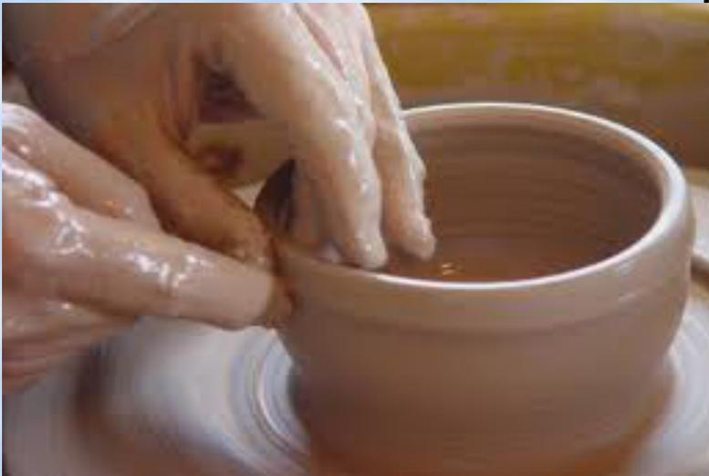
Le particelle elementari hanno carica superficiale negativa quindi interagiscono con l'acqua, la quale come dipolo, si dispone sulla superficie delle particelle neutralizzando la carica negativa e facendo così parte della struttura stessa.
