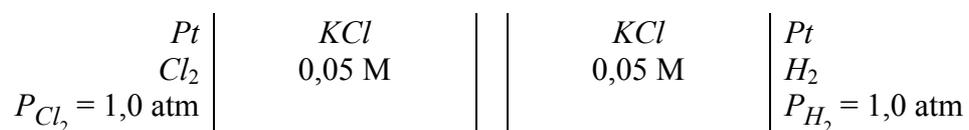
dopo aver scritto la reazione in ciascuna soluzione, le semi-reazioni redox in prossimità di ciascun elettrodo ed aver indicato esplicitamente le polarità, sapendo che  $E^\circ$  dell'elettrodo di sinistra vale  $+1,36 \text{ V}$ . Giustificare sinteticamente ogni passaggio.
