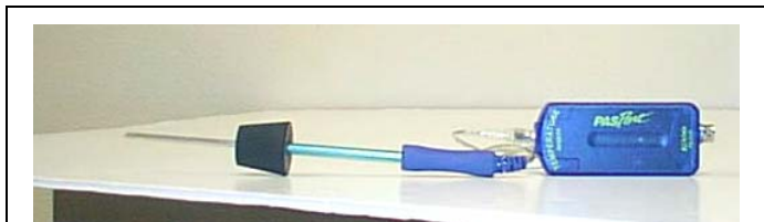
Figura 1: Sonda di temperatura con manicotto in plastica e tappo
