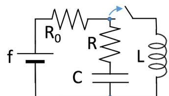
2) Prima dell'apertura dell'interruttore non c'è differenza di potenziale ai capi dell'induttanza ( $di/dt=0$ ) pertanto la corrente erogata dal generatore attraversa  $R_0$  e torna al generatore senza scorrere nel ramo con  $R$  e  $C$ :  $I(0^-) = f/R_0$ . Inoltre, dato che in  $R$  non scorre corrente la differenza di potenziale ai suoi estremi e quella della capacità sono entrambe nulle:  $Q(0^-) = 0$ .
