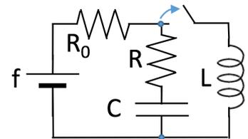
4) Nel circuito in figura  $f$  è un generatore di forza elettromotrice sinusoidale di valore efficace  $f_{\text{eff}}$ . Alla risonanza la differenza di potenziale ai capi di  $R$  è  $V_{\text{eff}} = f_{\text{eff}}/2$ . Determinare il valore di  $C$  sapendo che  $L = 0,1 \text{ H}$  e  $R = 100 \Omega$ .
