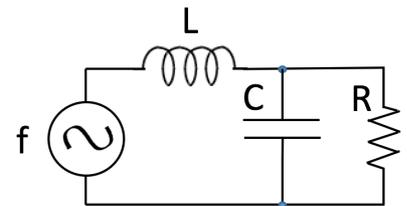
{la differenza di potenziale ai capi di  $R$  è data dalla partizione di  $f$  fra l'impedenza  $Z_L$  di  $L$  e quella del parallelo  $Z_p$  fra le impedenze di  $R$  e  $C$ . Determinata la funzione complessa  $Z = Z_p/(Z_L+Z_p)$  determinare la pulsazione corrispondente al massimo del suo modulo (risonanza)}
