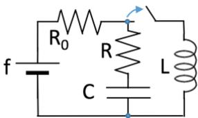
11.10) Il circuito in figura è a regime quando viene aperto l'interruttore. Dopo quanto tempo la differenza di potenziale ai capi di R è uguale a quella ai capi di C? Dati:  $f = 10 \text{ V}$ ;  $R = R_0 = 10 \text{ k}\Omega$ ;  $C = 0,2 \mu\text{F}$ ;  $L = 10 \text{ mH}$ .
