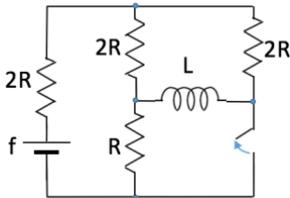
11.2) Determinare, per le due posizioni dell'interruttore, il valore dell'energia accumulata nell'induttanza in condizioni stazionarie
