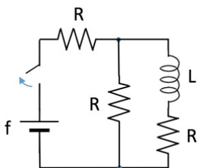
11.5) Il circuito in figura è a regime quando, al tempo  $t = 0$ , viene aperto l'interruttore. Calcolare la differenza di potenziale ai capi dell'induttanza al tempo  $t^* = 60$  μs.
