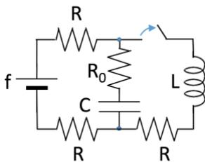
11.12) Il circuito in figura è a regime quando, al tempo  $t = 0$ , viene aperto l'interruttore. Ricavare l'espressione della corrente che scorre in  $R_0 = 2R$  per  $t > 0$
