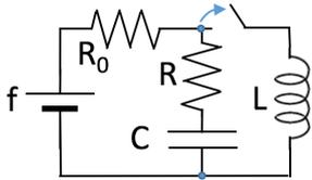
12.14) Il circuito in figura è a regime quando viene aperto l'interruttore. Dopo quanto tempo la differenza di potenziale ai capi di R è uguale a quella ai capi di C? Dati:  $f = 10 \text{ V}$ ;  $R = R_0 = 10 \text{ k}\Omega$ ;  $C = 0,2 \mu\text{F}$ ;  $L = 10 \text{ mH}$ .
