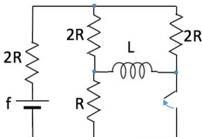
\*12.11) Determinare, per le due posizioni dell'interruttore, il valore dell'energia accumulata nell'induttanza in condizioni stazionarie
