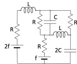
12.9) Determinare il valore dell'energia accumulata nelle capacità e nelle induttanze
