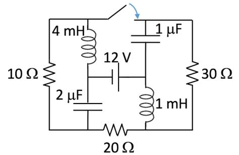
12.8) Determinare l'energia dissipata nella resistenza R dall'apertura dell'interruttore fino al raggiungimento della nuova condizione di equilibrio.
