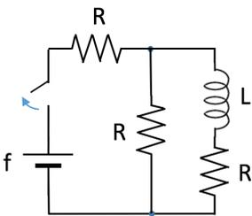
12.15) Il circuito in figura è a regime quando, al tempo  $t = 0$ , viene aperto l'interruttore. Calcolare la differenza di potenziale ai capi dell'induttanza al tempo  $t^* = 60 \mu\text{s}$ .
