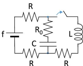
12.18) Il circuito in figura è a regime quando, al tempo  $t = 0$ , viene aperto l'interruttore. Ricavare l'espressione della corrente che scorre in  $R_0 = 2R$  per  $t > 0$
