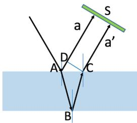
26) Un raggio luminoso incide in A con un angolo  $\theta = 30^\circ$  su una lastra di vetro ( $n = 3/2$ ) spessa  $d = 3 \text{ cm}$ . Il raggio viene in parte riflesso (raggio a) e in parte rifratto. Il raggio rifratto viene riflesso in B dalla superficie di uscita della lastra e, dopo un'ulteriore rifrazione in C, riemerge in aria (raggio a'). Determinare la distanza AD e la differenza temporale di arrivo dei raggi a e a' su uno schermo S posto perpendicolarmente ai due raggi.
