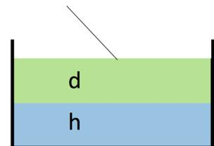
22) Sulla superficie di una vasca profonda  $h = 80$  cm galleggia una sorgente puntiforme che emette isotropicamente luce verso il basso. Sulla superficie dell'acqua ( $n = 4/3$ ) si osserva un cerchio luminoso dovuto alla riflessione sul fondo della vasca; determinarne il raggio.
