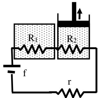
Il calore sviluppato in un tempo  $\tau$  nel bollitore e nello scaldatore a gas è quindi
