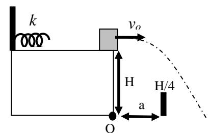
Il blocco sorvola l'ostacolo attraversando il piano  $x=a$  al tempo  $t=a/v_0$
