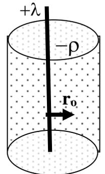
**2. Soluzione.** Il campo elettrico interno al cilindro può essere calcolato applicando la legge di Gauss alla superficie cilindrica  $\Sigma$  concentrica, di lunghezza  $L$  e di raggio interno  $r_o < R$
