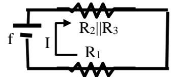
con una tensione ai capi dei due resistori  $\Delta V = I_2 R_2 = I_3 R_3 = I \cdot \frac{R_2 R_3}{R_2 + R_3} = \mathbf{40V}$
