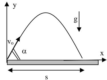
il tempo di volo si ottiene imponendo  $y(t)=0$  da cui  $t = \frac{2v_0 \sin \alpha}{g}$
