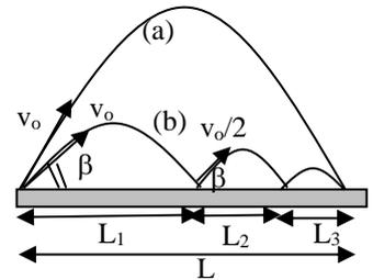
mentre il tempo complessivo  $t_b = \frac{2v_0 \sin \beta}{g} + \frac{v_0 \sin \beta}{g} + \frac{v_0 \sin \beta}{2g} = \frac{7v_0}{2g} \sin \beta = \mathbf{2.518 \text{ s}}$
