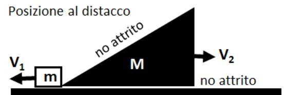
da cui le **velocità del cuneo**  $V_2 = \sqrt{2gh} \sqrt{\frac{m^2}{M(M+m)}} = \mathbf{1.71 \text{ m/s}}$ ,
