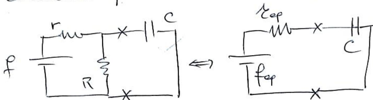
$$r_{th} = \frac{r \cdot R}{r + R} \quad ; \quad f_{th} = \frac{f R}{r + R} = 0,5 V$$
