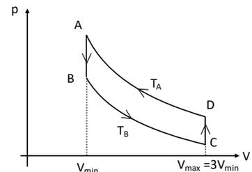
5b) il coefficiente di prestazione della pompa di calore è definito come il calore ceduto alla sorgente calda diviso per il lavoro totale prodotto:
