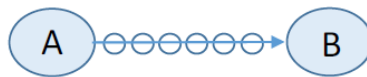
Figura 3.1.3 Trasformazioni ideali in cui il sistema si porta da A a B attraverso un numero infinito di stati di equilibrio.
