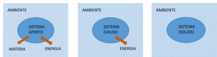
Figura 3.1.1 Rappresentazione schematica di sistemi termodinamici.
