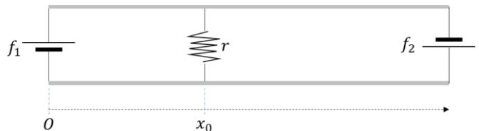
generatore di f.e.m.  $f_1$  la corrente nel carico è nulla. ( $f_1 = 10 \text{ V}$ ,  $f_2 = 30 \text{ V}$ ,  $l = 80 \text{ cm}$ ).
