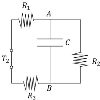
Quindi il condensatore si scarica attraverso la resistenza equivalente  $R_E$  data dal parallelo tra la serie  $R_1$  e  $R_3$  e la resistenza  $R_2$ , ovvero:
