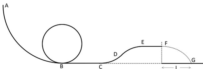
due tratti CD e DE di raggio  $R/2$  di concavità opposte, entrambi sottesi ad un angolo  $\frac{\pi}{4}$  e raccordati insieme. Questa salita immette in un tratto rettilineo orizzontale EF lungo 3 cm. Determinare la velocità delle macchinette nel punto F. In questo punto F la pista si interrompe bruscamente: con quale velocità (in modulo) le macchinette arriveranno in G? Trascurare gli attriti.
