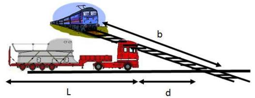
**1. Soluzione.** La valutazione della velocità (costante) del treno si ottiene misurando lo spazio percorso diviso il tempo impiegato a percorrerlo:  $v = \frac{\Delta s}{\Delta t} = \frac{500 - 350\text{ m}}{4\text{ s}} = 37.5\frac{\text{m}}{\text{s}}$
