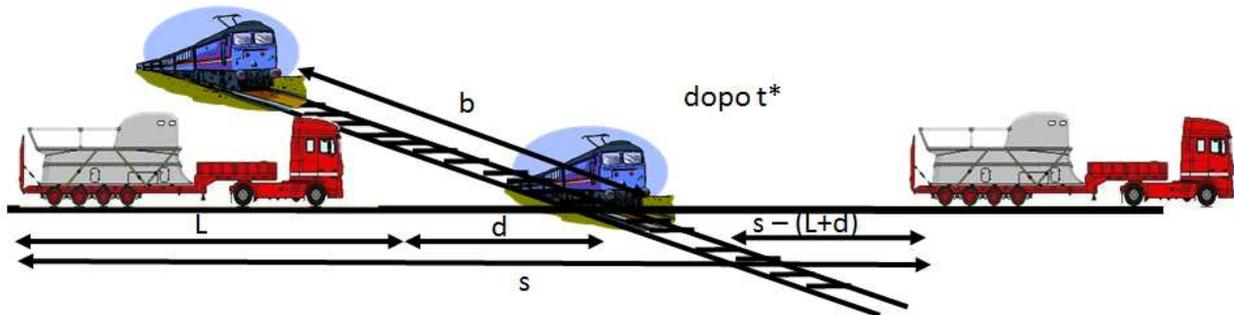
Circa il cinematismo del tir si decide di individuare come punto rappresentativo quello del paraurti posteriore. Se il paraurti posteriore, che dista inizialmente  $d+L=30\text{m}$  dall'intersezione, riesce a oltrepassare la linea ferrata entro il tempo  $t^*=9.33\text{ s}$ , allora il tir non verrà danneggiato dal treno. Quando sopraggiunge il treno ( $t^*=9.33\text{s}$ ) lo spazio percorso dal paraurti posteriore è
