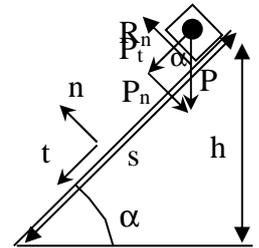
**Studio della cinematica:** l'accelerazione di caduta è  $a_t = g \sin \alpha = 4.14 \text{ m/s}^2$  (moto unif. accelerato). Integrando la velocità vale  $v(t) = a_t t$  (velocità iniziale nulla). Integrando
