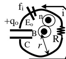
Applicando la legge di Faraday-Neumann-Lenz si calcola la forza elettromotrice indotta nella spira  $f_i = -\frac{d\Phi_C}{dt} = \frac{B_0 \pi r^2}{\tau_1}$  (la corrente tende quindi a circolare nel senso in figura)
