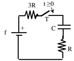
Nell'istante  $t=0$  di chiusura dell'interruttore T, nel circuito comincia a fluire una corrente di intensità variabile nel tempo di espressione
