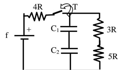
**3. Soluzione.** I condensatori nel ramo AB sono in serie ed equivalenti a  $C_{eq} = \frac{C_1 \cdot C_2}{C_1 + C_2} = 0.75 \mu\text{F}$ .
