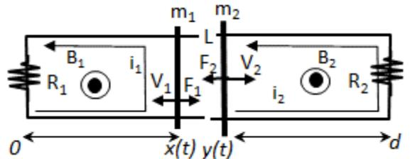
$$i_2 = -\frac{d\Phi_2}{dt} = -\frac{B_2 L}{R_2} \frac{d[d - y(t)]}{dt} = \frac{B_2 L V_2}{R_2} \text{ (la corrente è sempre nel verso in figura)}$$
