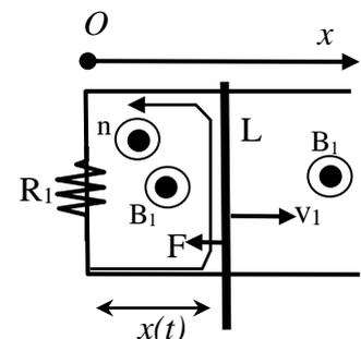
Applicando la legge di Faraday-Neumann-Lenz si calcola la forza elettromotrice indotta nella spira  $f_1 = -\frac{d\Phi_1}{dt} = -B_1 L v_1$  che porta alla corrente indotta  $i_1 = \frac{f_1}{R_1} = -\frac{B_1 L v_1}{R_1}$  che è negativa (la corrente tende quindi a circolare in senso inverso rispetto a quella in figura).
