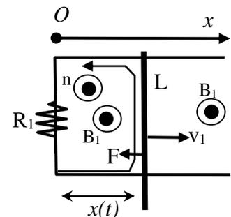
Applicando la legge di Faraday-Neumann-Lenz si calcola la forza elettromotrice indotta nella spirale  $f_1 = -\frac{d\Phi_1}{dt} = -B_1 L v_1$  che porta alla corrente indotta  $i_1 = \frac{f_1}{R_1} = -\frac{B_1 L v_1}{R_1}$  che è negativa (la corrente tende quindi a circolare in senso inverso rispetto a quella in figura).
