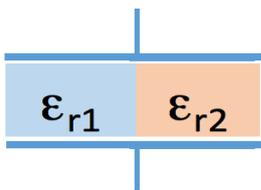
5.19) Un condensatore a facce piane e parallele ha nel vuoto una capacità  $C_0 = 10 \text{ nF}$ . Viene riempito per metà volume con un dielettrico di costante relativa  $\epsilon_{r1} = 1,4$  e per l'altra metà con un dielettrico di costante  $\epsilon_{r2} = 1,6$ . Calcolare il nuovo valore della capacità  $C$  e il rapporto fra le cariche di polarizzazione sui due dielettrici.
