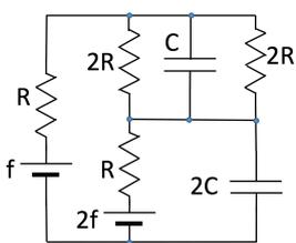
5.8) Calcolare quanta energia è accumulata e quanta potenza viene dissipata nel circuito in figura in cui  $f = 10$  V,  $R = 100$   $\Omega$ ,  $C = 100$  nF
