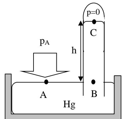
depressione cui corrisponde una diminuzione dell'altezza della colonna di  $\Delta h$ . La pressione in questocaso  $p_A = \rho_{Hg}g(h - \Delta h) = \rho_{Hg}gh(1 - \Delta h/h) = p_{atm}(1 - \Delta h/h) = p_{atm}(1 - 20/760) = 0.974\text{Atm} = 98634\text{ Pa}$
