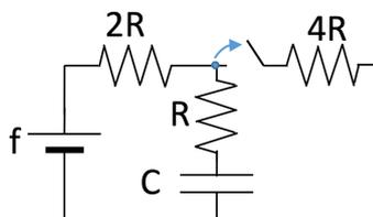
9) Il circuito in figura è a regime quando, all'istante  $t = 0$ , viene aperto l'interruttore. Determinare l'espressione della carica del condensatore in funzione del tempo
