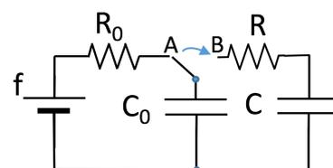
11) Il circuito in figura è a regime. Determinare il valore della differenza di potenziale  $V_B - V_A$  e delle cariche sulle armature positive dei due condensatori.
