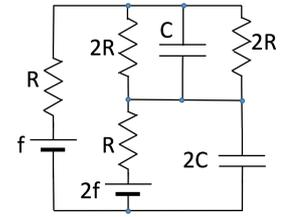
**6\_11)** Calcolare quanta energia è accumulata e quanta potenza viene dissipata nel circuito in figura in cui  $f = 10 \text{ V}$ ,  $R = 100 \Omega$ ,  $C = 100 \text{ nF}$
