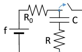
8) Nel circuito in figura i valori delle resistenze sono uguali a  $R$ . Determinare l'andamento temporale della differenza di potenziale  $V(t) = V_A - V_B$  a partire dall'istante in cui:
