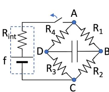
**6\_12\_rev)** Il circuito in figura (ponte di Wheatstone) è alimentato da un generatore  $f = 12 \text{ V}$  di resistenza interna  $R_{int} = 160 \Omega$ . Le altre resistenze valgono  $R_1 = 400 \Omega$ ,  $R_2 = 800 \Omega$ ,  $R_3 = 200 \Omega$ ,  $R_4 = 100 \Omega$ . La capacità del condensatore è  $C = 20 \mu\text{F}$ .
