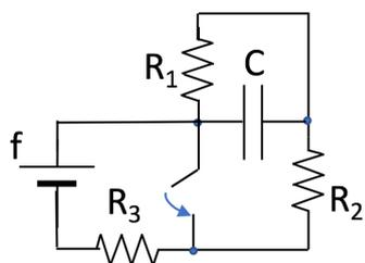
6) Il circuito in figura è in condizioni stazionarie quando, all'istante  $t = 0$ , viene chiuso l'interruttore. Determinare l'espressione della differenza di potenziale  $V_C(t)$  ai capi del condensatore.
