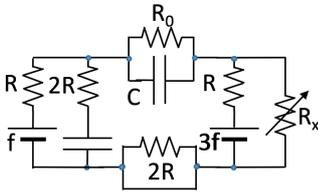
**6\_10)** Determinare il valore di  $R_x$  per il quale non scorre corrente in  $R_0$ .
