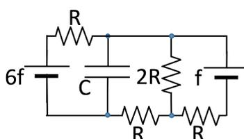
**4)** Calcolare l'energia accumulata negli elementi del circuito in figura e le potenze  $P_1$  e  $P_2$  erogate (o assorbite) a regime dai generatori posti rispettivamente nella prima e seconda maglia. Dati:  $f = 10 \text{ V}$ ,  $R = 10 \Omega$ ,  $C = 1 \mu\text{F}$ .
