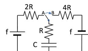
12) Il circuito in figura è in condizioni stazionarie con il deviatore nella posizione A. Determinare l'andamento della corrente nel condensatore a partire dall'istante in cui il deviatore commuta nella posizione B.
