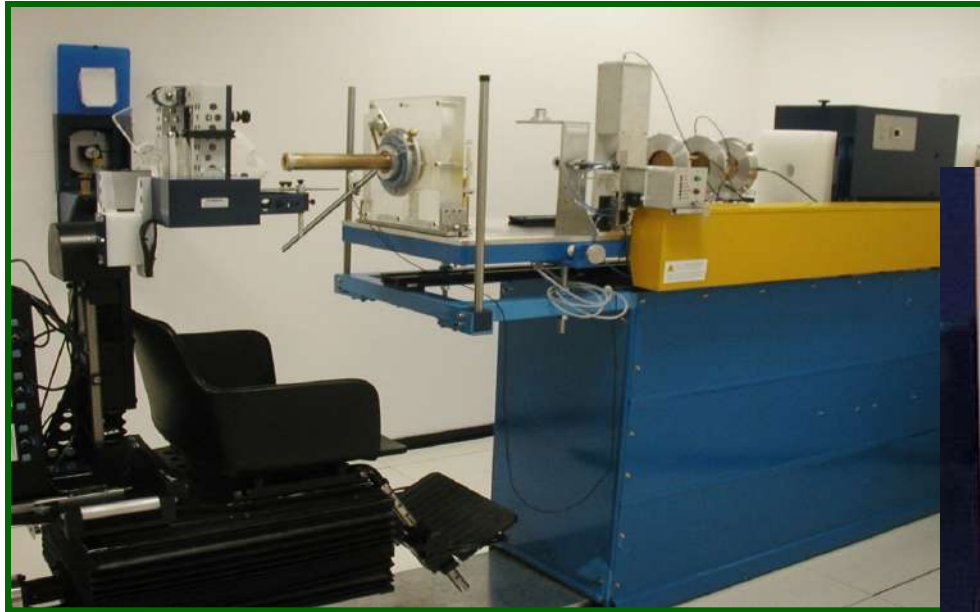
Fascio di protoni da 62 MeV accelerato da un "ciclotrone"
