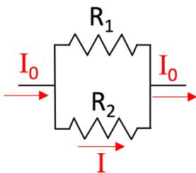
3) partitore di corrente (circuito che permette di ridurre la corrente erogata da un generatore).
