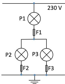
Vengono inserite nel circuito in figura in cui sono protette con fusibili tarati per intervenire (interrompere il circuito) se attraversati da correnti superiori a:  $F_1 = 4,3 \text{ A}$ ;  $F_2 = 3,2 \text{ A}$  e  $F_3 = 0,9 \text{ A}$ .
