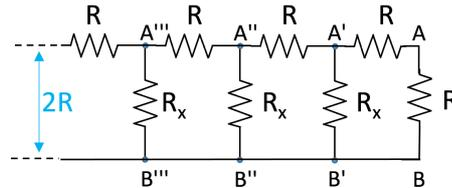
1b) determinare il valore delle resistenze  $R_x$
