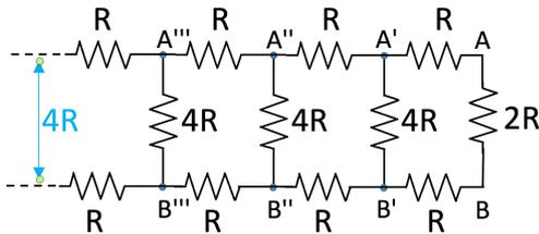
Verificare che, anche ripetendo infinite volte la struttura riportata in figura, la resistenza equivalente fra i punti indicati dalla freccia vale  $4R$ .
