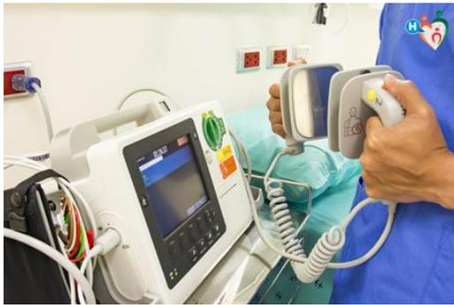
Una batteria da  $5 \text{ kV}$  viene collegata a un condensatore di capacità  $C = 30 \mu\text{F}$  che quindi immagazzina una grande quantità di energia. Una volta carico, gli elettrodi vengono applicati sul petto del paziente ed il circuito viene chiuso: l'energia si scarica attraverso una corrente che fluisce tra le due piastre attraverso il corpo umano (che è un buon conduttore elettrico).
