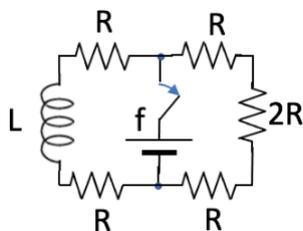
5) Il circuito in figura ( $f = 10 \text{ V}$ ;  $R = 1 \text{ k}\Omega$ ;  $L = 12 \text{ mH}$ ) è a regime quando, all'istante  $t = 0$  si apre l'interruttore. Dopo quanto tempo la corrente nell'induttanza vale  $1 \text{ mA}$ ?
