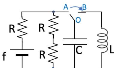
7) All'istante  $t = 0$  il deviatore commuta dalla posizione A alla posizione B e la carica inizia ad oscillare. Determinare la massima intensità di corrente che successivamente scorre nel condensatore
