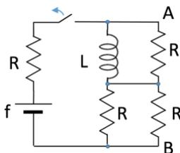
3) Determinare l'espressione della tensione  $\Delta V_{AB}(t)$  presente tra i punti A e B dopo l'apertura dell'interruttore.
