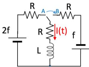
4) Nel grafico è riportato l'andamento della corrente  $I(t)$  a partire dall'istante in cui il deviatore commuta da A a B. Sapendo che  $L = 0,2 \text{ H}$  determinare il valore di  $f$ .
