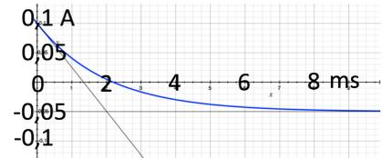
5) Prima della chiusura dell'interruttore la capacità da  $400 \text{ nF}$  ha un'energia di  $1 \mu\text{J}$ . Dopo quanto tempo dalla chiusura dell'interruttore l'induttanza da  $0,1 \text{ H}$  ha per la prima volta la stessa energia?
