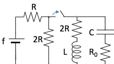
7) Determinare l'energia che viene dissipata nella resistenza  $R_0=R$  dall'istante in cui si apre l'interruttore fino a quando la carica del condensatore termina di oscillare.
