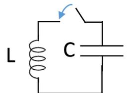
6) Un condensatore di capacità  $1 \text{ nF}$  viene caricato da una differenza di potenziale di  $0,5 \text{ V}$  e poi collegato a un'induttanza di  $0,1 \text{ H}$ . Determinare la frequenza della corrente che scorre nel circuito e il suo valore massimo.
