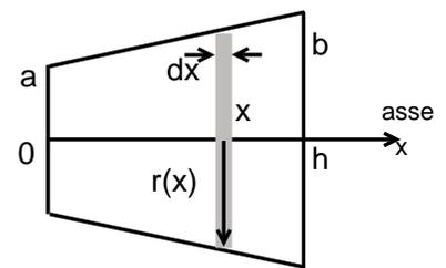
Nel caso di un conduttore cilindrico  $a = b$ , la  $R$  diventa quella di un conduttore cilindrico di lunghezza  $h$  e sezione  $\pi a^2$ :  $R = \rho h / \pi a^2$ .
