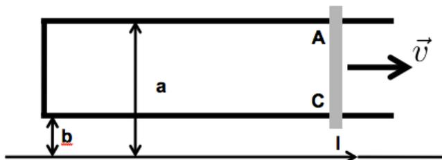
Tale sbarretta garantisce un doppio contatto elettrico strisciante nei punti  $A$  e  $C$  e viene tenuta, da una opportuna forza esterna, in moto traslatorio rettilineo uniforme a velocità  $v$ . Nell'ipotesi che tutto sia nel vuoto, ricavare l'espressione (intensità e verso) della corrente  $i$  che passa nel circuito. Trascurare gli effetti di autoinduzione.
