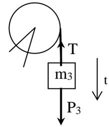
2c) Equazione per il blocco n.3 lungo l'asse del moto t
