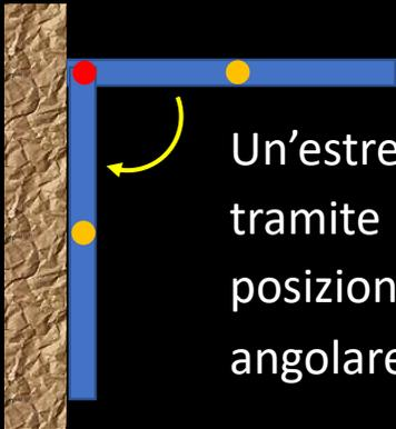
Un'estremità di un'asta sottile omogenea di massa  $m = 2 \text{ kg}$  e lunga  $L = 50 \text{ cm}$  è fissata a una parete tramite una cerniera (l'attrito sviluppa un momento costante  $M_{\text{Att}} = 2 \text{ Nm}$ ). L'asta, inizialmente ferma in posizione orizzontale, viene lasciata libera di ruotare verso la parete. Determinare l'accelerazione angolare nell'istante in cui l'asta inizia a ruotare e l'energia cinetica al momento dell'urto.
