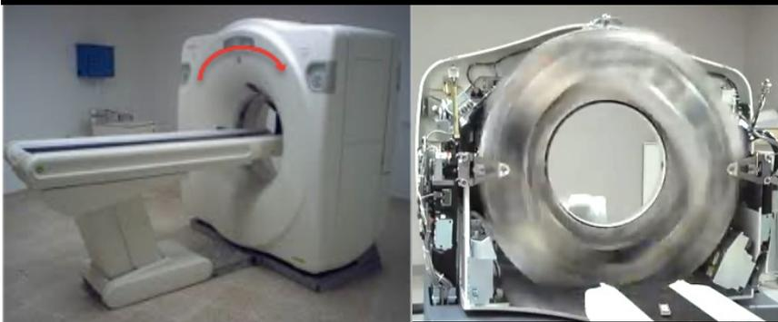
L'apparato rotante di un tomografo a raggi X può essere schematizzato come un anello omogeneo di diametro interno 80 cm, diametro esterno 1,4 m e massa 800 kg. Quanto lavoro deve compiere il motore per portarlo da fermo alla massima velocità di rotazione che è 3 giri/s? [ $I = \frac{1}{2} M (R_{int}^2 + R_{ext}^2)$ ] [L = 46,2 kJ]
