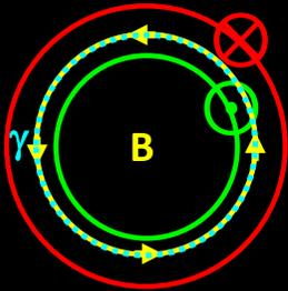
4) Un cavo coassiale è costituito da due superfici cilindriche concentriche di raggi  $R_1$  e  $R_2 > R_1$  in cui scorre la stessa intensità di corrente ma in versi opposti.
