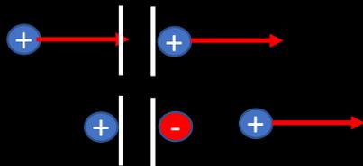
fra le armature non c'è **corrente di conduzione** ma
