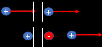
fra le armature non c'è **corrente di conduzione** ma
