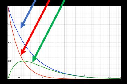
$$= C f \left(1 - e^{-\frac{t}{RC}}\right) \frac{f}{RC} e^{-\frac{t}{RC}} = \frac{f^2}{R} \left(e^{-\frac{t}{RC}} - e^{-\frac{2t}{RC}}\right)$$
