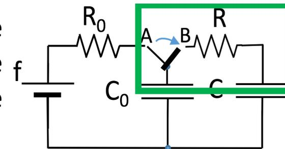
Determinare l'energia che viene dissipata in  $R$  dall'istante della commutazione fino a quando non viene ristabilito l'equilibrio.
