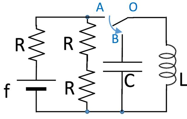
Il condensatore è scarico quando, all'istante  $t = 0$ , il deviatore commuta dalla posizione A alla posizione B e la corrente inizia ad oscillare. Determinare la massima carica del condensatore
