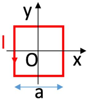
5) Una spira **quadrata** di lato  $a = 1 \text{ cm}$ , percorsa da una corrente  $I = 1 \text{ mA}$  circolante in verso antiorario, è disposta col centro nell'origine del piano  $(x,y)$  e con i lati paralleli agli assi. Nello spazio è presente un campo  $B$  di componenti  $B_x = B_y = 0$ ,  $B_z = B_0 (1 + y/a)$  con  $B_0 = 1 \text{ mT}$ . Determinare intensità, direzione e verso della forza agente sulla spira.
