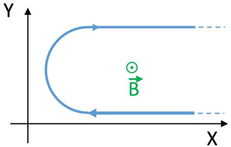
4) Un filo rigido percorso dalla corrente  $I$  è piegato nel piano  $XY$  in modo da formare una semicirconfenza di raggio  $R$  e due tratti rettilinei molto lunghi. Il filo è immerso in un campo magnetico  $B$  uniforme perpendicolare al piano  $XY$ . Determinare direzione intensità e verso della forza agente sul conduttore.
