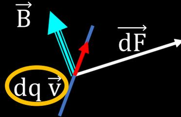
$$\vec{dF} = dq \vec{v} \times \vec{B} = dq \frac{d\vec{l}}{dt} \times \vec{B} = \frac{dq}{dt} d\vec{l} \times \vec{B} = I d\vec{l} \times \vec{B}$$
