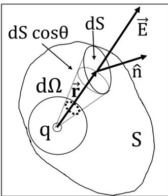
il flusso del campo elettrico attraverso una superficie CHIUSA che racchiude una carica puntiforme  $q$  è:
