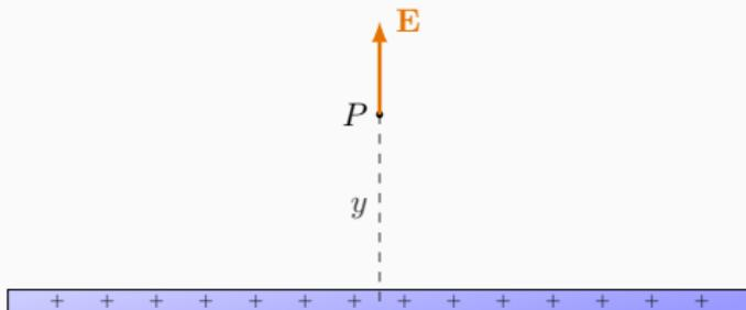
Il campo elettrico di un filo infinitamente lungo è in ogni punto a distanza  $y$  dal filo, perpendicolare al filo e di modulo  $E = \lambda/2\pi\epsilon_0 y$ , quindi
