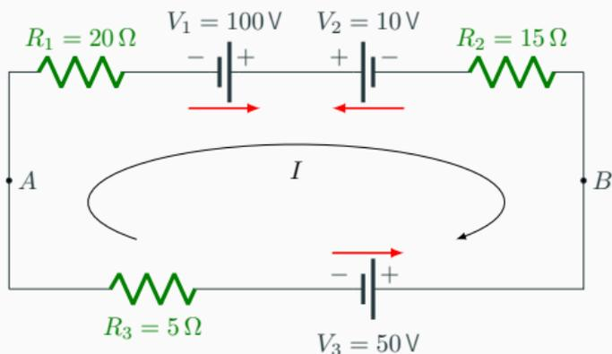
Per trovare la differenza di potenziale tra i punti  $A$  e  $B$ , si può indifferentemente considerare: 1) il tratto di circuito attraverso  $V_1$  e  $V_2$  o 2) il tratto di circuito attraverso  $V_3$ .
