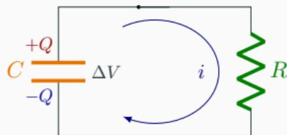
3. Il condensatore nei riguardi di  $R$  funziona come un generatore di f.e.m. variabile e resistenza interna nulla.
