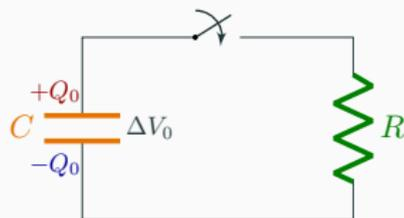
1. Cariche fluiscono (corrente  $i$ ) attraverso  $R$  ed energia viene dissipata.
